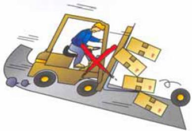
5、下坡或轉彎時車速應減慢，下坡時應以倒車方式行駛，以免車輛翻覆與物品飛落。
