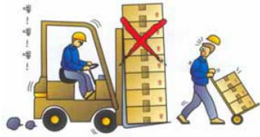
2、使用堆高機搬運物品時，不可堆疊太高妨礙駕駛視線，如物品太大，請以倒車方式行駛；堆高機應裝設警報裝置以提示其他勞工留意安全。
