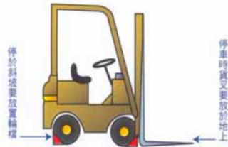
4、停車時手剎車要拉緊，貨叉要置於地上，原動機熄火制動，如停於斜坡處要放置輪擋。
